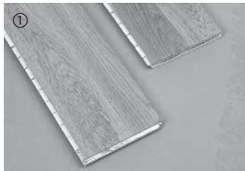
① Elemento sinistro. Elemento destro. Per la posa a spina di pesce sono necessari elementi sinistri e destri. Elemento sinistro: scanalatura femmina sul lato frontale superiore e lungo il bordo longitudinale sinistro. Elemento destro: scanalatura femmina sul lato frontale superiore e lungo il bordo longitudinale destro.
