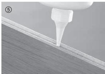
La posa delle file successive avviene solo mediante incollaggio maschio-femmina. Stendere il collante in modo continuo sul lato femmina superiore.
