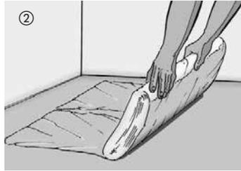
② En règle générale, il faut toujours poser un film en polyéthylène de 0,2 mm d'épaisseur sur toutes les chapes et lors d'une pose sur un chauffage au sol. Les raccords des couches de film doivent se chevaucher sur environ 30 cm. Relever le film sur le mur et le couper après le montage des plinthes sur l'arête supérieure de ces dernières. **Comme le sol en liège HARO dispose d'ores et déjà d'une sous-couche en liège intégrée, il ne faut pas poser une sous-couche acoustique supplémentaire.**
