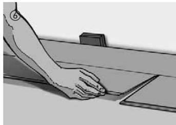
⑥ La deuxième rangée peut être commencée avec le reste de la première rangée (décalage des joints en bout d'élément d'au moins 40 cm). Ainsi on évite trop de chutes. Poser les autres lames les unes après les autres. Pour ce faire, les lames sont d'abord emboîtées sur la longueur sous l'effet d'une légère pression exercée dans la liaison.
