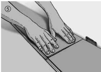
⑤ Les autres lames de la première rangée doivent être encliquetées par le haut au niveau des extrémités dans la lame précédente. En appuyant légèrement sur le chant transversal, la lame s'enclenche dans la lame voisine. Veillez à respecter un alignement exact des lames. La dernière lame de la première rangée est coupée en respectant le jeu de dilatation de 10 à 15 mm par rapport au mur et emboîtée.
