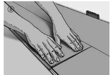
⑧ La lame est abaissée à l'about. Veillez à cet égard que la lame soit glissée sur l'about aux abords de l'arête de la lame posée précédemment. En appuyant légèrement sur le chant transversal, la lame s'enclenche.
