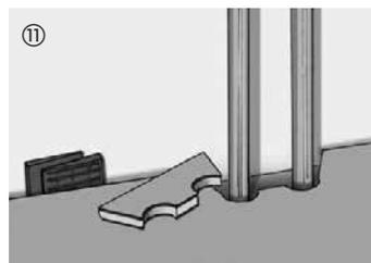
⑪ Découper ou percer des ouvertures pour les tuyaux de chauffage sortant du sol (selon la taille des tuyaux et sans oublier le jeu de dilatation).
