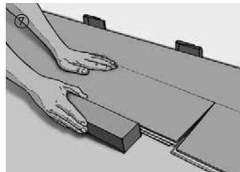
⑦ Si nécessaire, taper doucement avec la cale de frappe.
