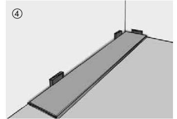
④ Pour commencer, poser les premières lames au coin droit de la pièce avec la languette côté mur et fixer à l'aide de cales biseautées (respecter un jeu de dilatation de 10 à 15 mm par rapport au mur).
