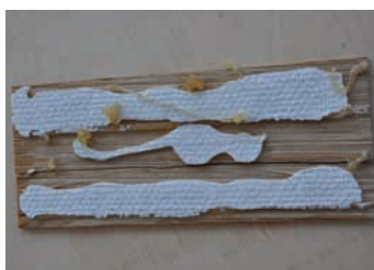
Vedhæftningskontrol med et Wall-prøveemne
