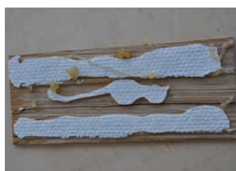
Gitterschnitttest und Klebebandabriss Haftungsprüfung mit Wall Probestück
