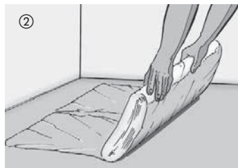
② In generale, su tutti i massetti e in caso di posa con riscaldamento a pavimento è necessario utilizzare un foglio di polietilene dello spessore di 0,2 mm e sovrapporlo di 30 cm nell'area di giunzione. Successivamente il foglio va sollevato lungo la parete e tagliato lungo il bordo superiore dopo il montaggio del battiscopa.
