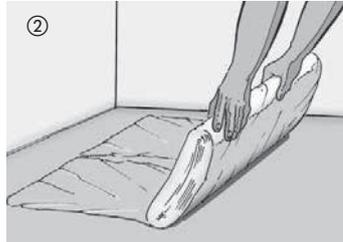
En règle générale, il faut toujours poser un film en polyéthylène de 0,2 mm d'épaisseur sur toutes les chapes et lors d'une pose sur un chauffage au sol. Les raccords des feuilles doivent se chevaucher sur environ 30 cm. Relever la feuille sur le mur et la couper, après le montage des plinthes, sur l'arête supérieure de ces dernières.
