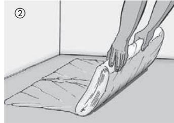
Es necesario extender una lámina de PE de 0,2 mm de grosor en todos los solados y al efectuarse la instalación sobre calefacción de suelo radiante, debiendo solaparse 30 cm en la zona de unión. A continuación, levantar la membrana por la pared y, tras la instalación de los zócalos, cortarla a ras con el borde superior de éstos.
