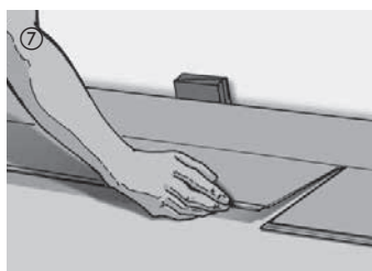
⑦ Start med resten af det afskårne stykke fra første række i den næste række (enderne skal forskydes mindst 50 cm, ved fliseformat mindst 1/3 af elementlængden). Derved reduceres spildet meget. Lægningen fortsættes element for element. Først drejes elementerne på langs ind i samlingen med et let tryk.
