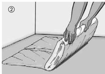
Es necesario extender una lámina de PE de 0,2 mm de grosor en todos los solados y al efectuarse la instalación sobre calefacción de suelo radiante, debiendo solaparse 30 cm en la zona de unión. A continuación, levantar la membrana por la pared y, tras la instalación de los zócalos, cortarla a ras con el borde superior de éstos. Puesto que el suelo ya posee una base insonorizante de corcho incorporada, no se debe instalar ninguna base insonorizante adicional.
